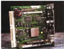
Sulla scheda elettronica, l'alto livello di integrazione è raggiunto grazie all'effetto di chip custom.
